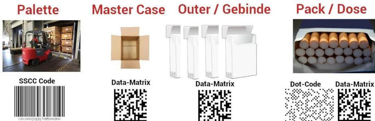
Darüber hinaus sind auf den Stangen, Master Cases und Paletten eindimensionale bzw. zweidimensionale Codes angebracht. Diese lassen sich mit 2D-Scannern erfassen. Für die Dotcodeerfassung sind unter anderem der **Zebra TC51/TC56** sowie der **Zebra MC3300** geeignet.
